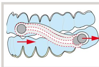
La leggera azione elastica del congiuntore a doppia S aumenta il confort d'uso e riduce i picchi di carico nella zona di fissaggio dei componenti.
